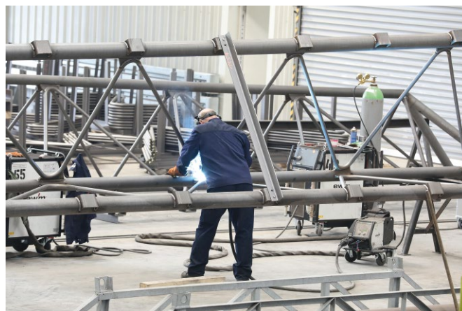
Bild 3 Die neuen Schweißmaschinen sind stromsparende, elektronisch geregelte Anlagen The new welding machines are power-saving, electronically regulated systems
